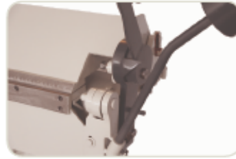
Kolay Çene Kilitleme mekanizması Easy Jaw lock mechanism
