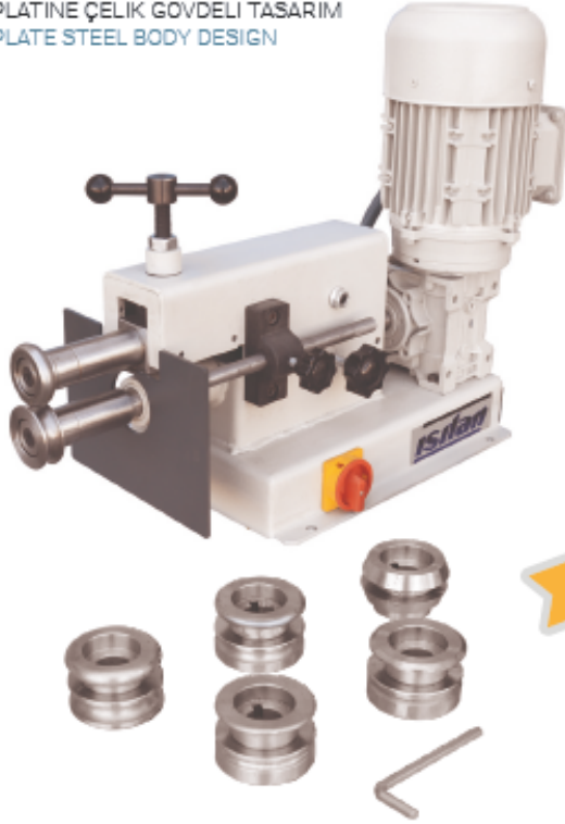
6 takım standart vals topu ve top açma anahtarı 6 set of standard rolls and roll spanner key
