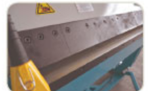
Arkor Kaplama Sert Parçalı Biçaklar Arcor Nitrocarburized hardened blades
