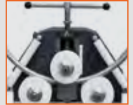
Paslanmaz Malzeme Kıvrımına Özel Delrin Vals Topları Plastic Rolls For Stainless Steel Bending
