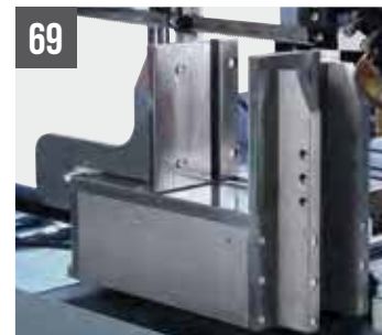
SHARK 230 NC HS 5.0 Gedeelde voorste klem
