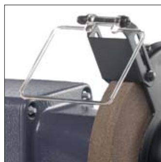
Stabiele opklapbare polycarbonaat oogbeschermlazen
