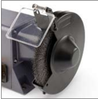
Staaldraadborstel veilig binnen de beschermkap te monteren
