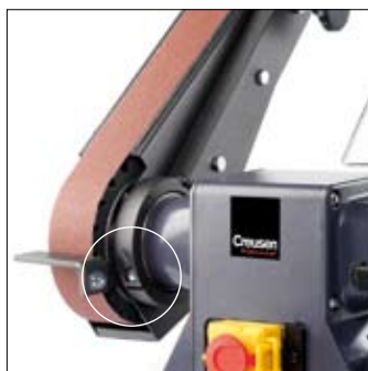
Bandslijpinrichting in hoogte verstelbaar
