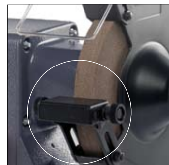
Stabiele dubbelzijdig bevestigde slijpsteunen, handmatig verstelbaar
