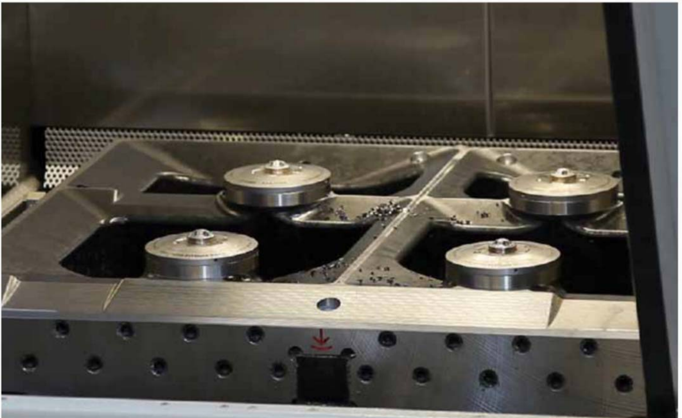
High-End Spannmöbelturbine (Bes.Nr. 420919) im Einsatz in einem vollautomatisierten Fertigungsprozess mit Rob Beladung.
