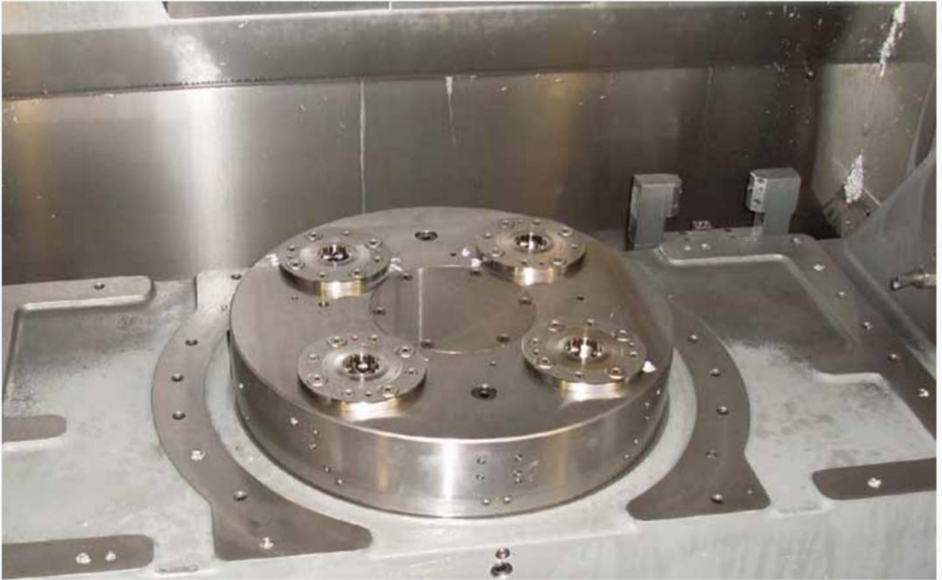
Alternativierlösung (Bes.Nr. 427161) mit Verriegelungs- und Abgekantung des wie Nippelabfrage im Einsatz in einem vollautomatisierten Fertigungsprozess mit Rob Beladung.
