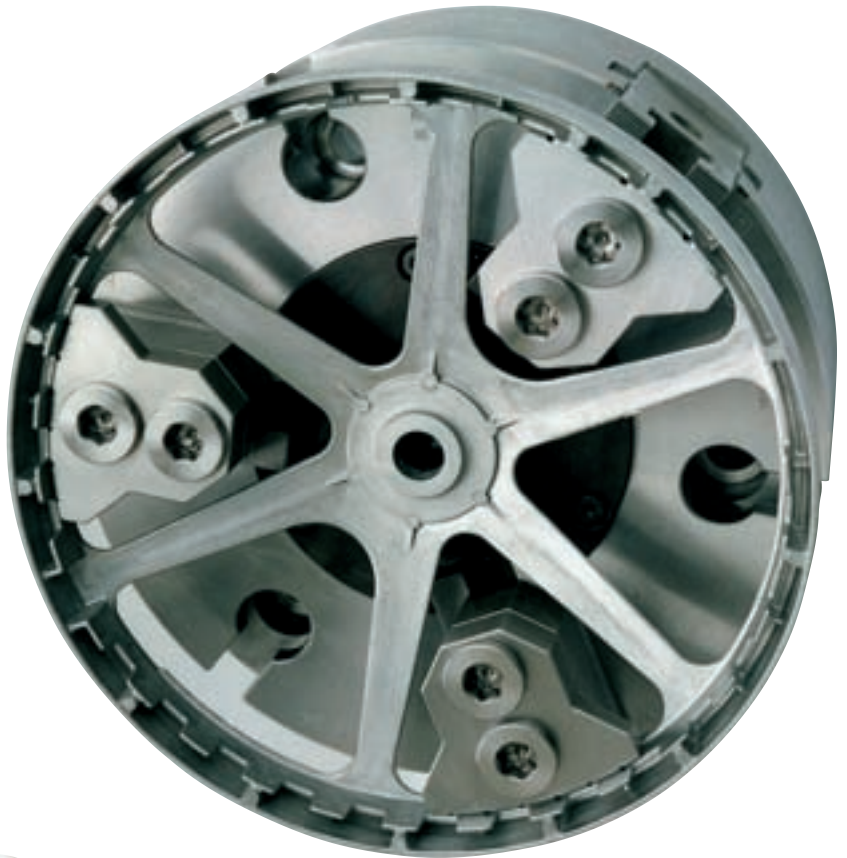
Pendelbacke mit Zwischenbacken, zum Spannen von dünnwandigen Werkstücken
