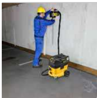
Gecertificeerde zuiger en ontstopper voor het opnemen van gezondheidsschadelijke stoffen volgens EN 60335-2-69.
