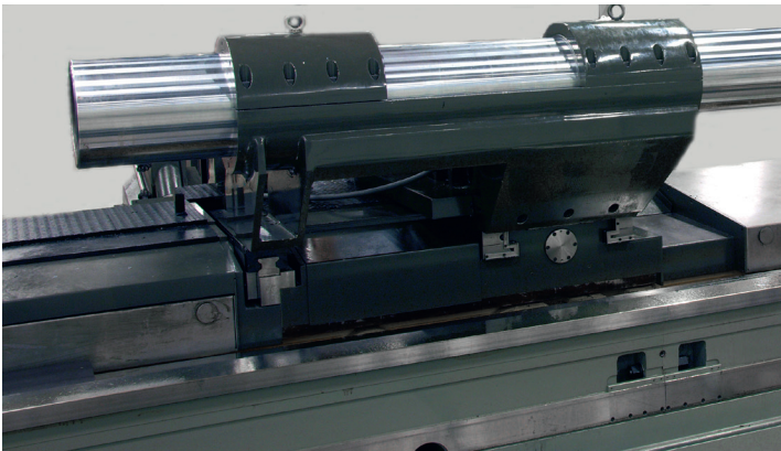
Gespleten houder voor 300 mm (11.81 inch) baardiameter. De afstand tussen kruissledes is 1200 mm (47.24 inch) (4 x BD).
